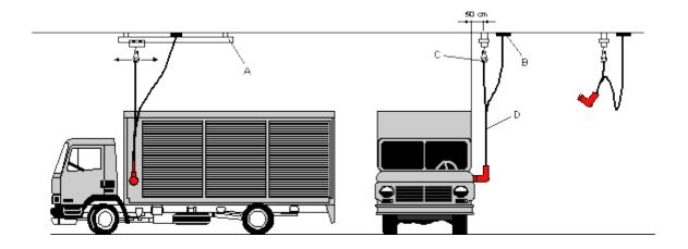
Für die Montage des Aufrollautomaten (C) in der Fahrzeughalle wählen Sie einen Punkt an der Decke, dessen Lotrechte sich ca. 50 cm seitlich vom Fahrzeug und genau auf Höhe der Einbaukupplung am Fahrzeug befindet (siehe Abbildung).
